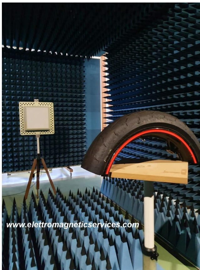
Misure su di un'antenna integrata in un dispositivo TPMS (Tyre Pressure Monitoring System) per pneumatici di moto sportive.
