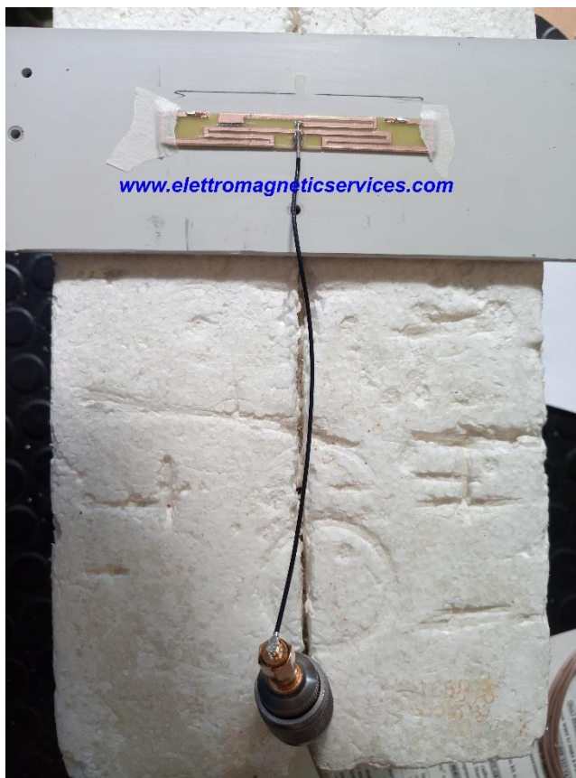
Misura dell'effetto del dielettrico su di un'antenna integrata.
