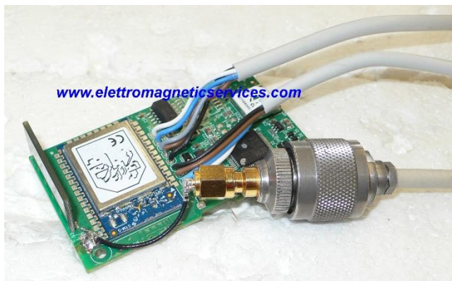
Misure preliminari su di un'antenna integrata preesistente, al fine di determinare delle specifiche di riferimento, rispetto alle quali effettuare dei miglioramenti.
